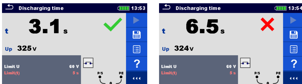
Figuur 4. 126: Resultaten van de ontladingstijd
