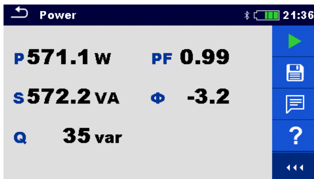
Figuur 4. 149: Power CLAMP resultaten
