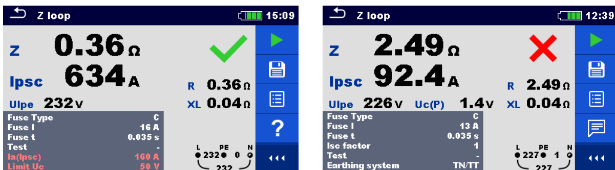
Figuur 4. 43: Voorbeeld van meetresultaat aardcircuitimpedantie
