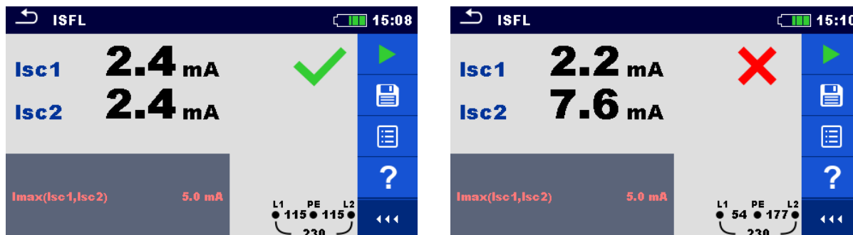
Figuur 4. 113: Voorbeelden meetresultaat ISFL lekstroommeting
