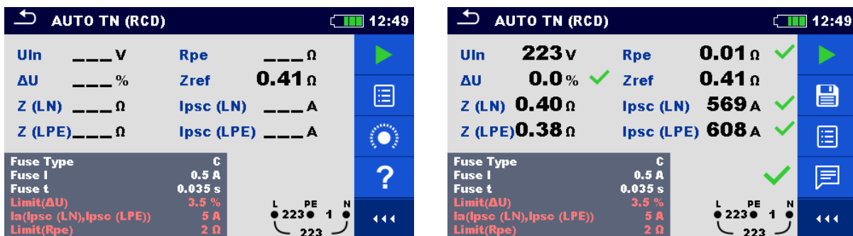
Figuur 4. 132: Voorbeelden van AUTO TN (RCD) meetresultaten
