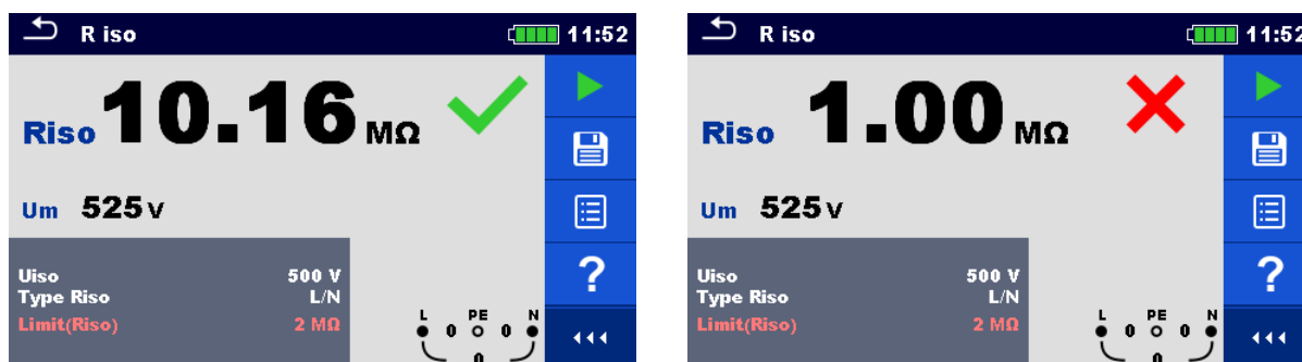
Figuur 4. 9: Voorbeelden van het meetresultaat van de isolatieweerstand
