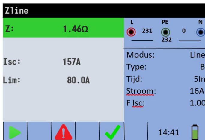
Figuur 5-337: Voorbeeld van meetresultaten lijnimpedantie
