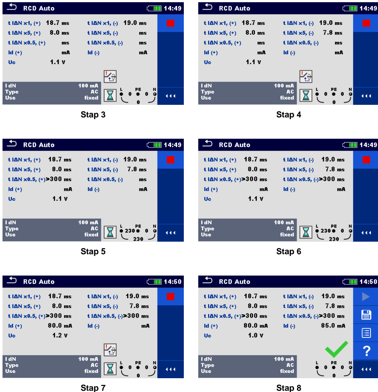
Figuur 4.27: Individuele stappen in RCD Autotest
