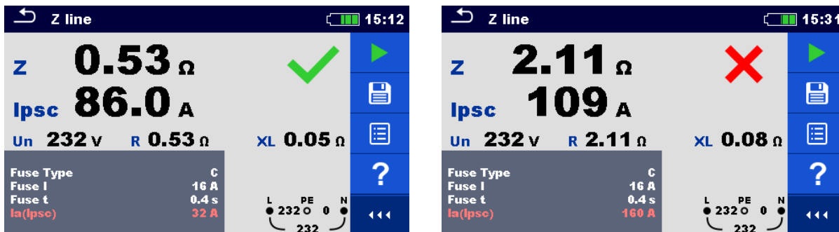
Figuur 4.40: Voorbeelden van circuitimpedantie meting
