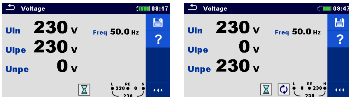
Figuur 4.4: Voorbeelden van spanningsmeting in 1-fase systeem
