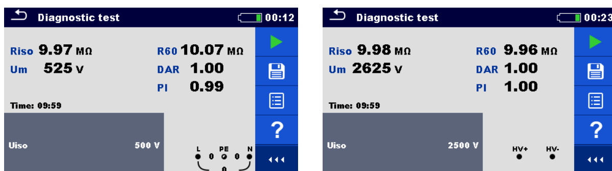
Figuur 4.13: Voorbeelden van Diagnostische test resultaten
