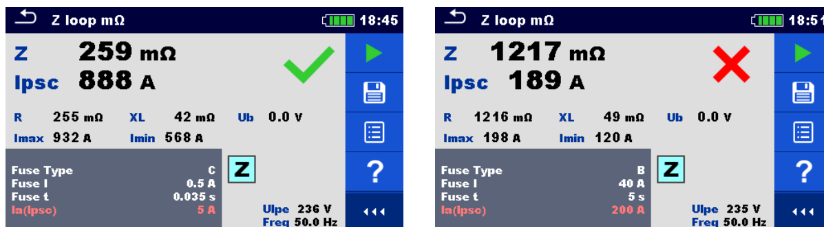
Figuur 4.37: Voorbeelden van high precisie lusimpedantie metingen
