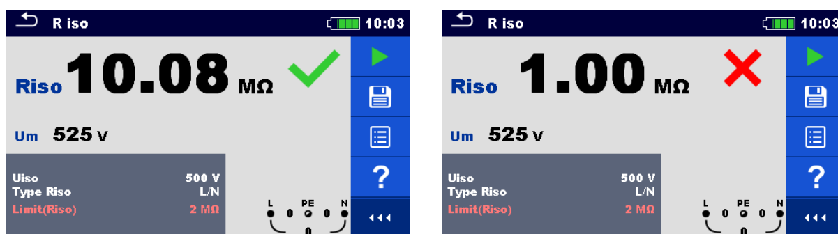
Figuur 4.9: Voorbeelden van resultaten van Isolatieweerstand metingen
