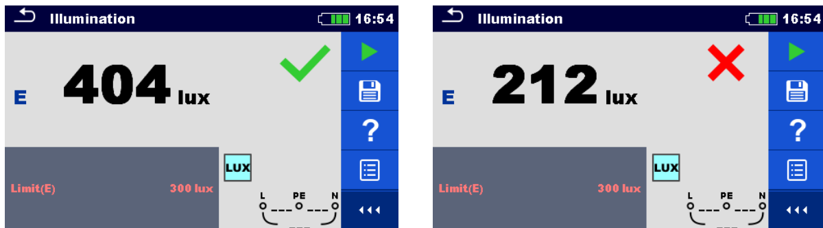
Figuur 4.79: Voorbeelden van verlichtingssterkte resultaten
