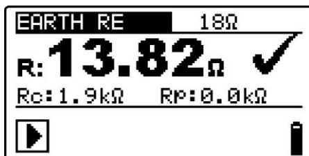
Figure 5.35: Exemple de résultat de mesure de la résistance de terre
