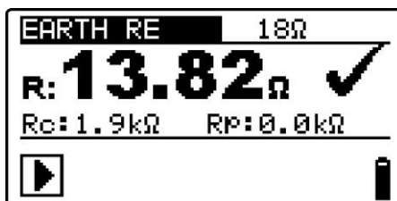
Afbeelding 5.35: Voorbeeld van het meetresultaat van de aardweerstand
