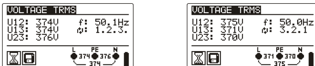
Figur 5.4: Exempel på spänningsmätning i trefassystem
