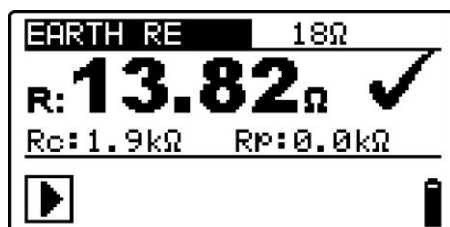
Bild 5.35: Beispiel eines Ergebnisses der Erdungswiderstandsmessung
