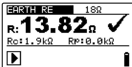
Figura 5.35: Esempio di risultato della misurazione della resistenza di terra
