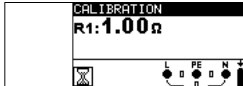
Rysunek 5.14: Wyniki ze starymi wartościami kalibracji
