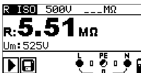
Figura 5.7: Ejemplo de resultado de la medición de la resistencia del aislamiento
