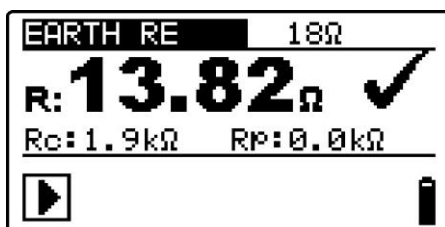
Figura 5.35: Ejemplo de resultado de la medición de la resistencia de tierra
