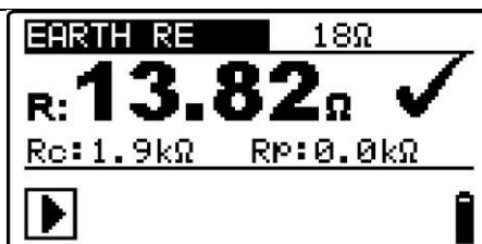
Figur 5.35: Exempel på resultat av mätning av jordmotstånd
