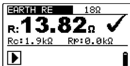
Rysunek 5.35: Przykładowy wynik pomiaru rezystancji uziemienia
