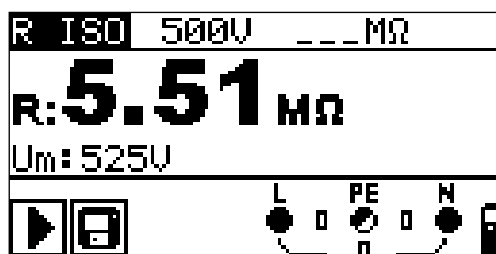
Figura 5.7: Esempio di risultato della misurazione della resistenza di isolamento
