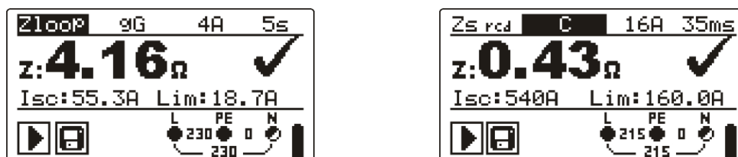
Bild 5.25: Beispiele für Messergebnisse der Schleifenimpedanz
